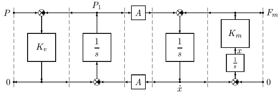
Scegliendo  $\mathbf{x} = [P_1 \ \dot{x} \ x]^T$  come vettore di stato, scrivere le equazioni dinamiche del sistema nello spazio degli stati nel caso in cui  $u = P$  sia l'ingresso ed  $y = F_m$  l'uscita:
