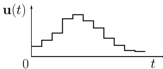
Il segnale  $\mathbf{y}(t)$  campionato con periodo  $T$  genera il segnale discreto  $\mathbf{y}(kT)$ . Il comportamento ingresso-uscita del sistema complessivo è quello di un sistema tempo discreto:
