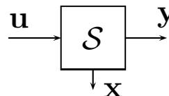
Se  $(\mathbf{A}, \mathbf{B})$  è raggiungibile, utilizzando una retroazione statica dello stato è possibile posizionare a piacere gli autovalori del sistema retroazionato  $\mathcal{S}_K$ :
