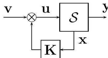
Se lo stato  $\mathbf{x}$  non è accessibile, allora occorre introdurre nell'anello di controllo un osservatore dello stato. Lo schema di controllo che tipicamente si utilizza è il seguente:
