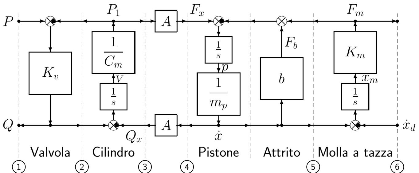
Le sezioni indicate a tratteggio nello schema POG rappresentano “sezioni reali” del sistema fisico attraverso le quali fluisce una potenza il cui valore è pari al prodotto delle variabili che caratterizzano la sezione tratteggiata dello schema a blocchi.
