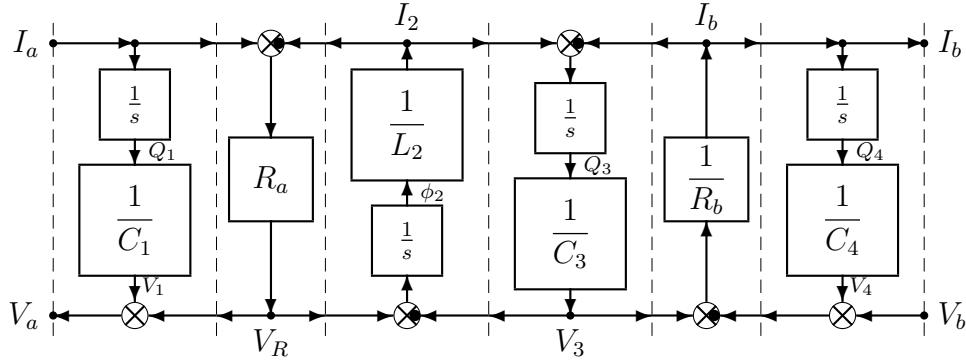
Sia  $\mathbf{x} = [V_1 \ I_2 \ V_3 \ V_4]^T$  il vettore di stato,  $\mathbf{u} = [I_a \ V_b]^T$  il vettore degli ingressi e  $\mathbf{y} = [V_a \ I_b]^T$  il vettore delle uscite. Scrivere il corrispondente sistema dinamico  $\bar{\mathbf{L}}\dot{\mathbf{x}} = \bar{\mathbf{A}}\mathbf{x} + \bar{\mathbf{B}}\mathbf{u}$  e  $\mathbf{y} = \bar{\mathbf{C}}\mathbf{x} + \bar{\mathbf{D}}\mathbf{u}$  nello spazio degli stati:
