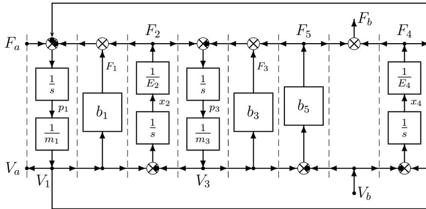
Sia  $\mathbf{x} = [V_1 \ F_2 \ V_3 \ F_4]^T$  il vettore di stato,  $\mathbf{u} = [F_a \ V_b]^T$  il vettore degli ingressi e  $\mathbf{y} = [V_a \ F_b]^T$  il vettore delle uscite. Scrivere il corrispondente sistema dinamico  $\bar{\mathbf{L}}\dot{\mathbf{x}} = \bar{\mathbf{A}}\mathbf{x} + \bar{\mathbf{B}}\mathbf{u}$  e  $\mathbf{y} = \bar{\mathbf{C}}\mathbf{x} + \bar{\mathbf{D}}\mathbf{u}$  nello spazio degli stati:
