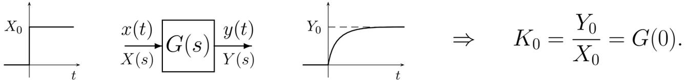
Utilizzando il criterio del valore finale è facile dimostrare che il guadagno statico  $K_0$  di un sistema  $G(s)$  coincide con  $G(0) = G(s)|_{s=0}$ , cioè con il valore della funzione  $G(s)$  per  $s = 0$ :
