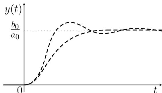
**Esempio.** Calcolare l'andamento qualitativo della risposta  $y(t)$  al gradino unitario della seguente equazione differenziale:
