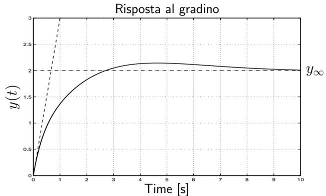
**Esempio.** Calcolare l'andamento qualitativo della risposta  $y(t)$  al gradino unitario della seguente funzione di trasferimento  $G(s)$ :
