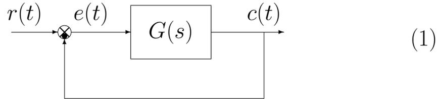
In questo schema semplificato la funzione  $G(s)$  descrive il guadagno di anello del sistema, cioè il prodotto delle funzioni di trasferimento che descrivono il regolatore, il sistema controllato e il sensore.
