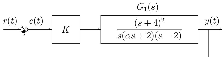
**a1)** Posto  $\alpha = 1$ , tracciare qualitativamente il luogo delle radici del sistema retroazionato al variare del parametro  $K > 0$ . Determinare la posizione degli asintoti, le intersezioni  $\omega^*$  con l'asse immaginario e i corrispondenti valori del guadagno  $K^*$ . Determinare la posizione dei punti di diramazione “solo in modo qualitativo”.
