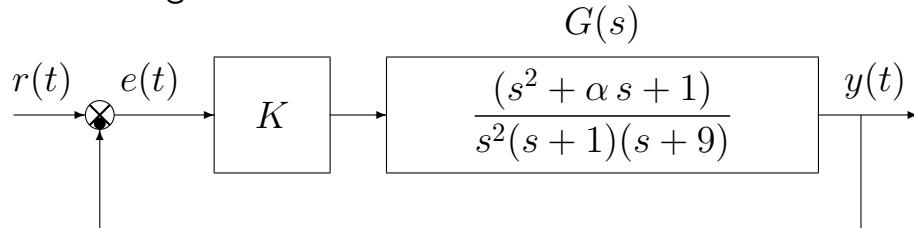
a.1) Posto  $\alpha = 1$ , tracciare qualitativamente il luogo delle radici del sistema retroazionato al variare del parametro  $K$ . Tracciare il luogo delle radici per  $K > 0$ . Determinare esattamente la posizione degli asintoti, le intersezioni  $\omega^*$  con l'asse immaginario e i corrispondenti valori del guadagno  $K^*$ . Determinare la posizione dei punti di diramazione “solo in modo qualitativo”.
