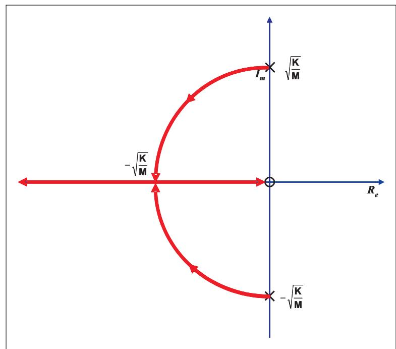
**Analisi parametrica al variare del parametro  $M$ .** L'equazione che descrive la dinamica del sistema può essere riscritta mettendo in evidenza il parametro  $M$ :
