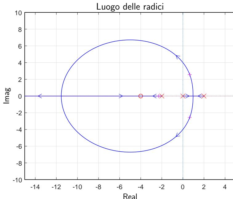
Il luogo delle radici è caratterizzato da un solo asintoto coincidente con il semiasse reale negativo. Le intersezioni con l'asse immaginario si determinano utilizzando il criterio di Routh. Equazione caratteristica:
