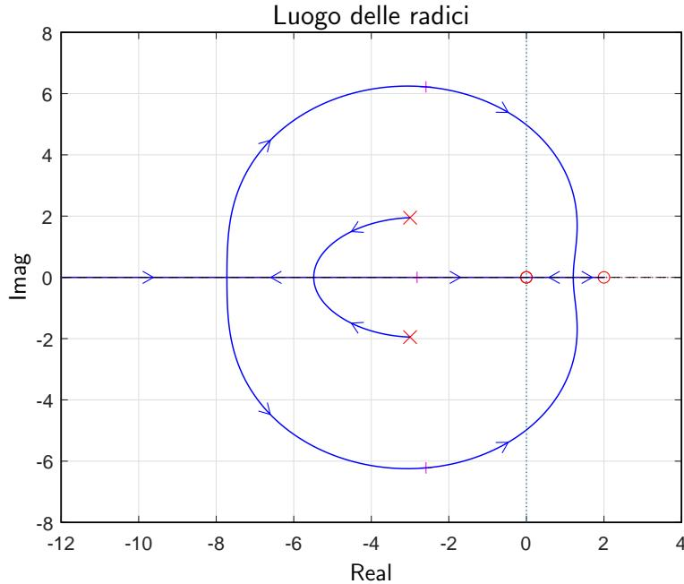
Il contorno delle radici ha un solo asintoto coincidente con il semiasse reale negativo e percorso dall'infinito al finito.
