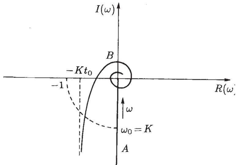
L'introduzione del polo nell'origine consente di ridurre a zero l'errore a regime nella risposta al gradino e costituisce, nella pratica, un accorgimento frequentemente adottato per la stabilizzazione dei sistemi in retroazione che presentino ritardi finiti di notevole entità.
