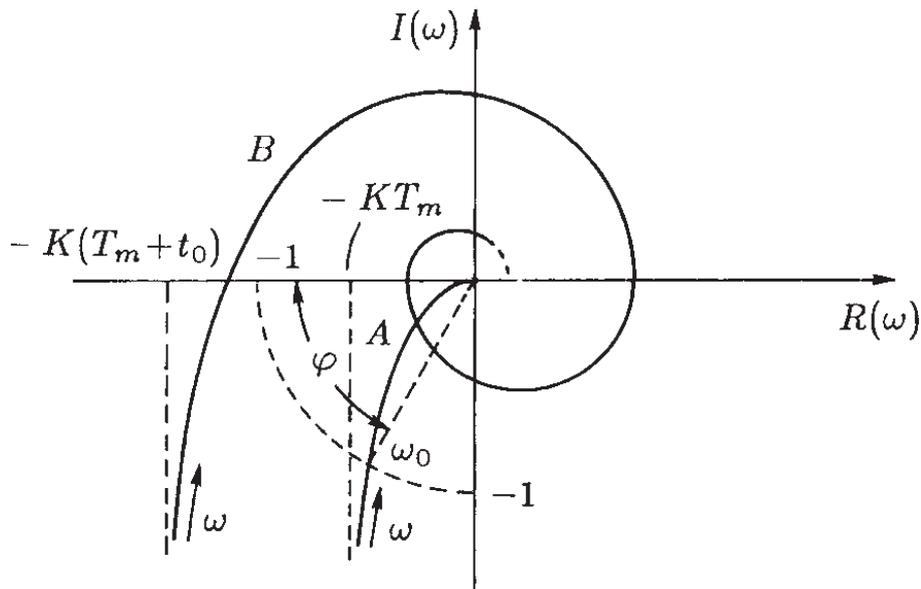
Per la presenza del ritardo finito, ogni vettore viene sfasato in ritardo dell'angolo  $\omega t_0$ , proporzionale alla pulsazione, e il diagramma assume l'andamento a spirale indicato con  $B$  nella figura precedente.
