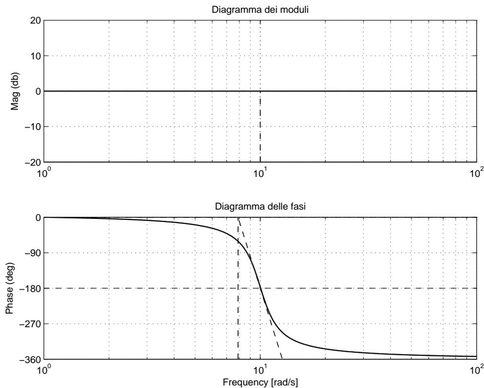
Figura 3: Diagrammi di Bode della funzione  $G(s)$ .
