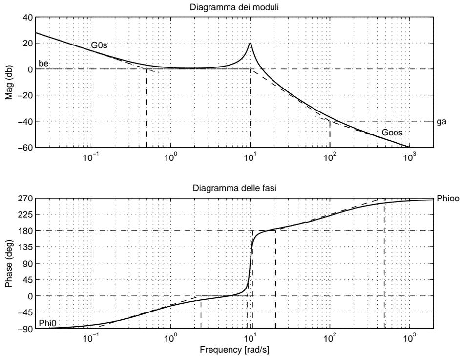
Figura 1: Diagrammi di Bode della funzione  $G(s)$ .
