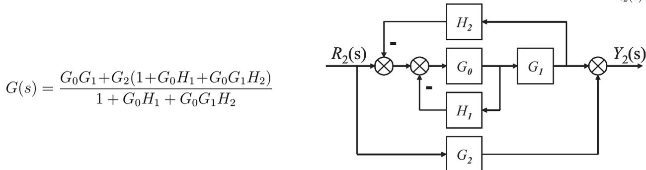
$$G(s) = \frac{G_0G_1 + G_2(1 + G_0H_1 + G_0G_1H_2)}{1 + G_0H_1 + G_0G_1H_2}$$
