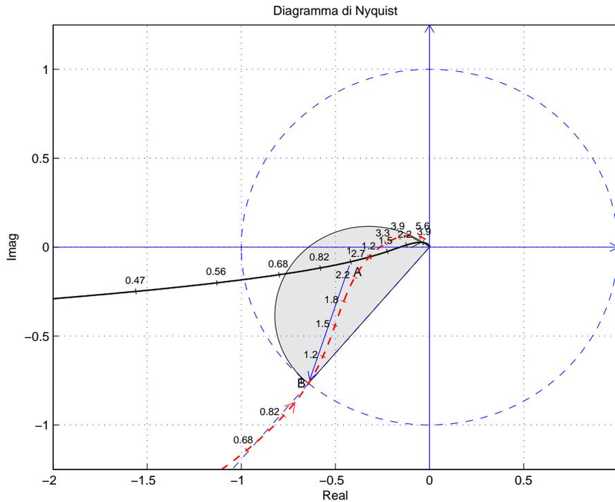
Figura 4: di Nyquist delle funzioni  $G_b(s)$  e  $C_2(s)G_b(s)$ .
