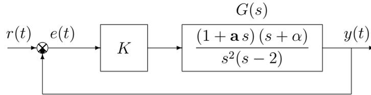
a.1) Posto  $\alpha = \mathbf{b}$ , tracciare qualitativamente il luogo delle radici del sistema retroazionato al variare del parametro  $K > 0$ . Determinare esattamente la posizione degli asintoti, le intersezioni  $\omega^*$  con l'asse immaginario e i corrispondenti valori del guadagno  $K^*$ . Determinare la posizione dei punti di diramazione "solo in modo qualitativo".
