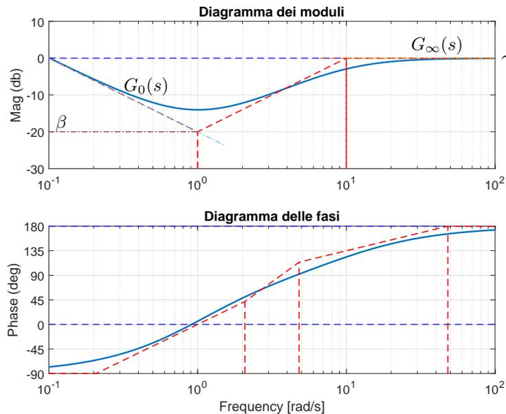
Figura 5: Diagrammi di Bode della funzione  $G_e(s)$ .
