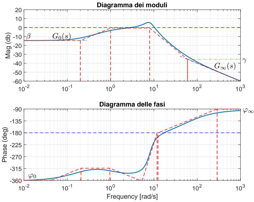
Figura 2: Diagrammi di Bode della funzione  $G(s)$ .
