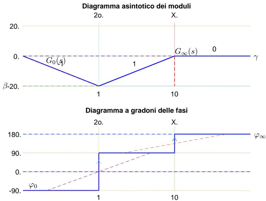
Figura 4: Diagrammi asintotici di Bode della funzione  $G_d(s)$ .
