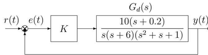
d.1) Determinare per quali valori di  $K$  il sistema retroazionato è asintoticamente stabile.
