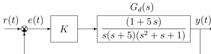
d.1) Determinare per quali valori di  $K$  il sistema retroazionato è asintoticamente stabile.
