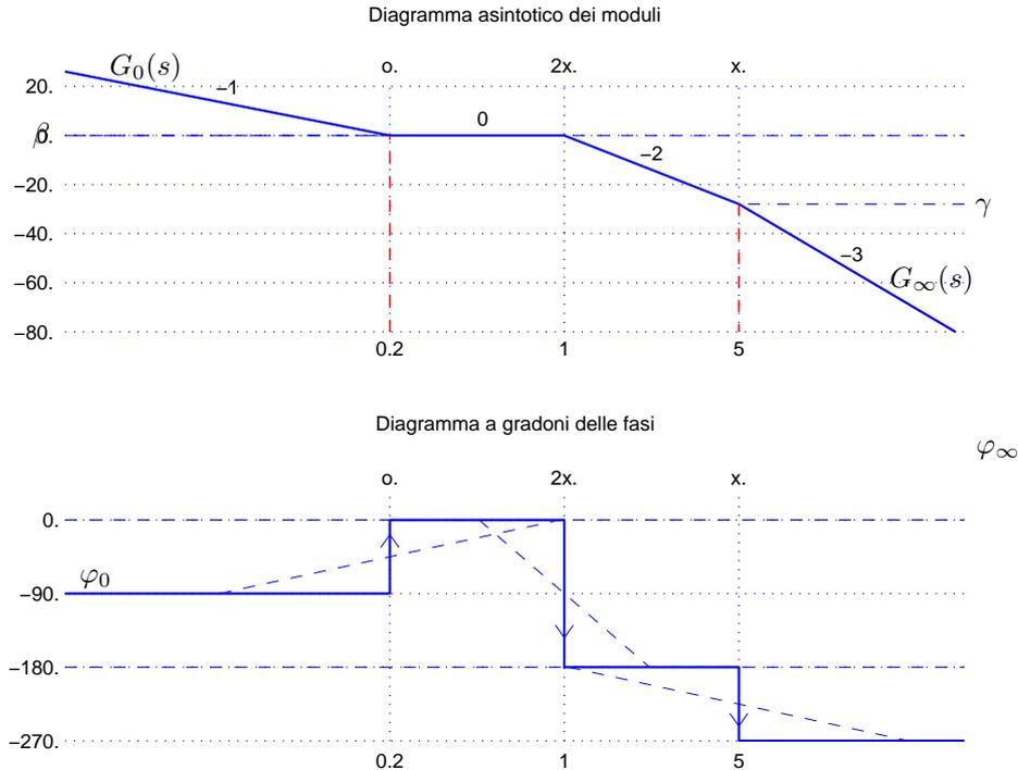
Figura 1: Diagrammi asintotici di Bode della funzione  $G_d(s)$ .
