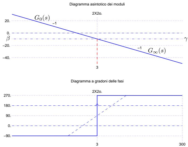
Figura 4: Diagrammi asintotici di Bode della funzione  $G_e(s)$ .
