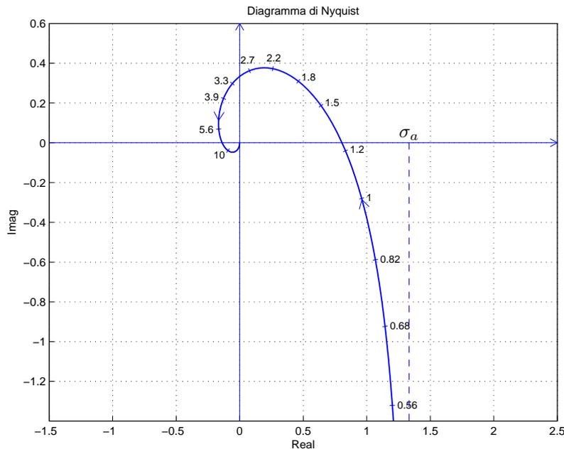
Figura 6: Diagramma di Nyquist della funzione  $G_e(s)$  per  $\omega \in [0, \infty]$ .
