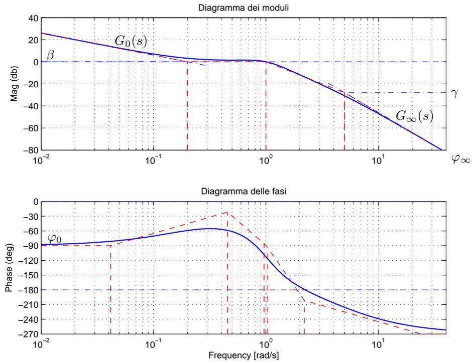
Figura 2: Diagrammi di Bode della funzione  $G_d(s)$ .
