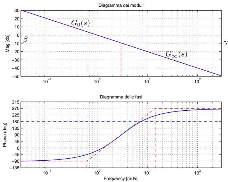
Figura 5: Diagrammi di Bode della funzione  $G_e(s)$ .
