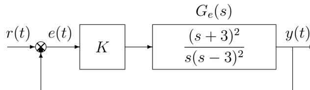
e.1) Determinare per quali valori di  $K$  il sistema retroazionato è asintoticamente stabile.
