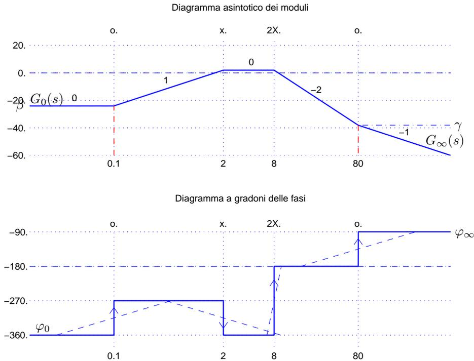
Figura 1: Diagrammi asintotici di Bode della funzione  $G_d(s)$ .
