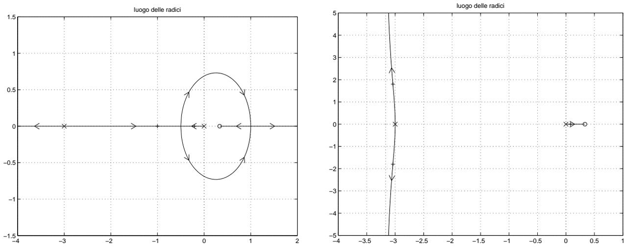
Figura 1: Luogo delle radici del sistema  $G(s)$  al variare del parametro  $K$  quando  $a = 3$  e  $b = 5$ . Le due figure sono relative, rispettivamente, ai casi  $K > 0$  e  $K < 0$ .
