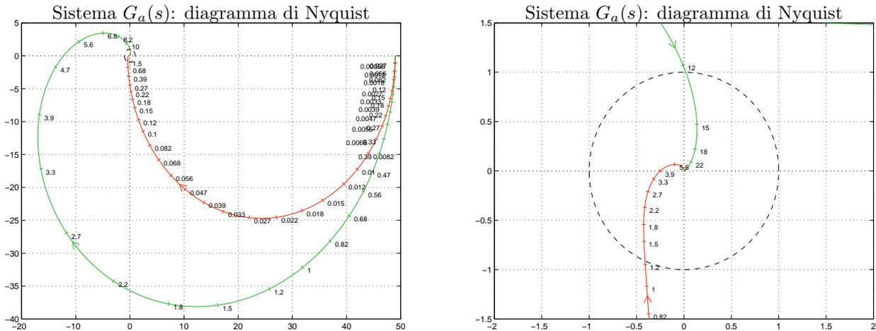
Figura 3: Diagramma di Nyquist del sistema  $K G_a(s)$  e zoom nell'intorno dell'origine.
