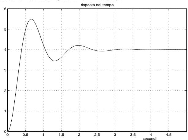
I parametri  $\sigma$  ed  $\omega$  si ricavano facilmente leggendo il tempo di assestamento  $T_a = 2$  s e il periodo dell'oscillazione  $T = 1.32$  s dalla risposta al gradino del sistema:
