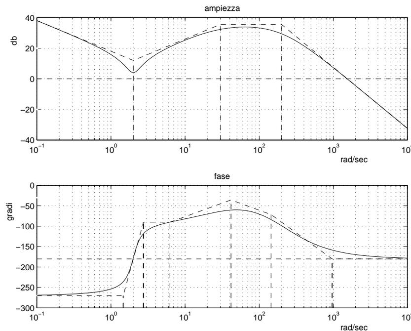
Figura 1: Diagrammi asintotici di Bode delle ampiezze e delle fasi della funzione  $G(s)$  nel caso  $a = 2, b = 6$ .
