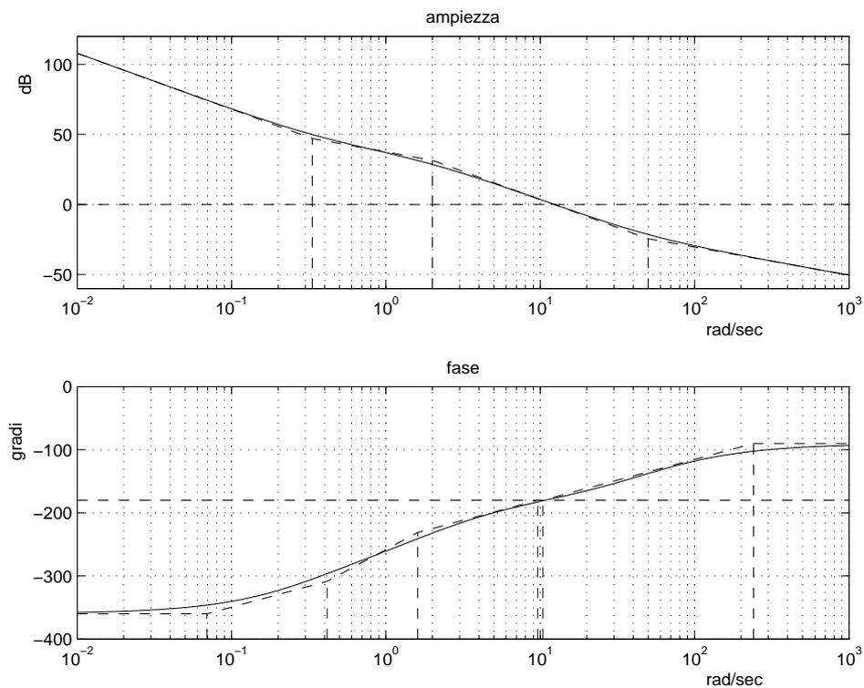
Figura 1: I diagrammi di Bode delle ampiezze e delle fasi della funzione  $G(s)$  quanto  $a = 3$  e  $b = 5$
