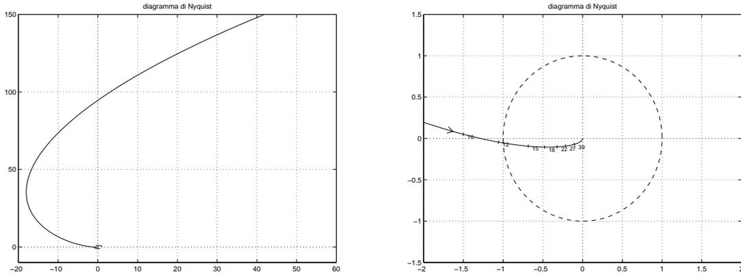
Figura 2: Diagramma di Nyquist della funzione  $G(s)$  quanto  $a = 3$  e  $b = 5$ . Il secondo diagramma è uno zoom del primo nell'intorno dell'origine.
