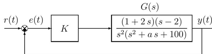
c.1) Determinare per quali valori del parametro  $K$  il sistema retroazionato è asintoticamente stabile.
