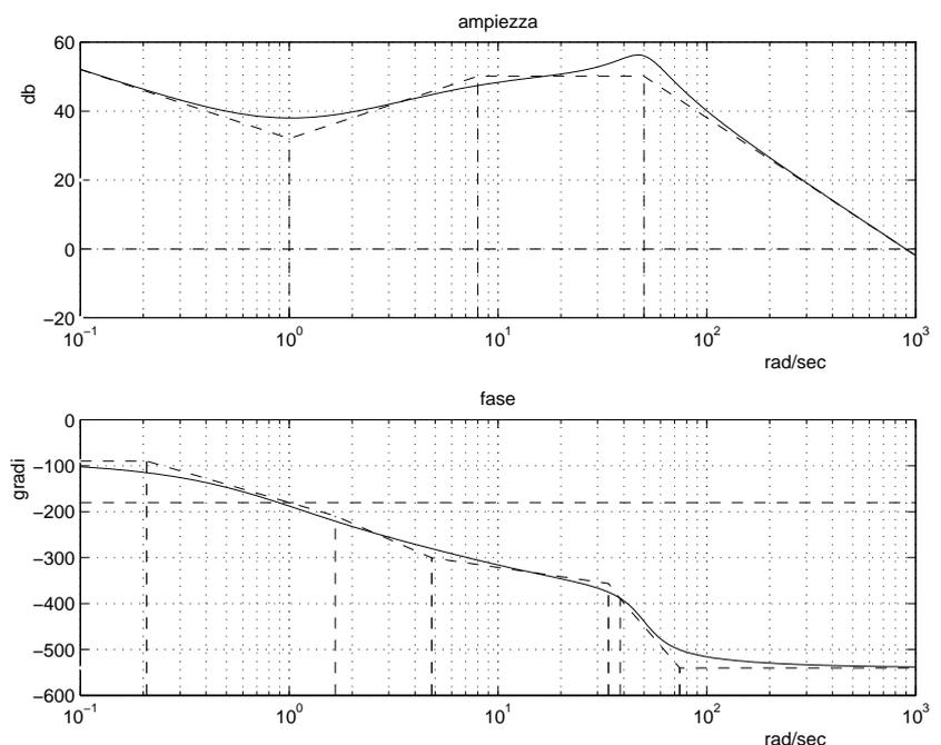
e) I diagrammi riportati sotto sono relativi a due sistemi a fase minima  $G_1(s)$  e  $G_2(s)$ .
