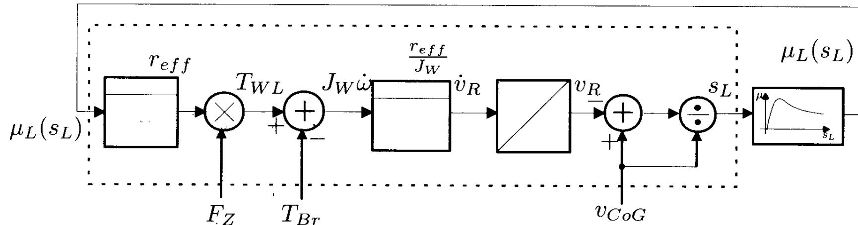
Aumentando la pressione  $p_{Br}$  aumenta la coppia applicata ai freni. Quando la differenza tra la coppia di attrito con il suolo e quella impressa dai freni è negativa, le ruote decelerano, la loro velocità  $v_R$  inizia a calare e lo slittamento  $s_L$  (in modulo) aumenta: il coefficiente di attrito  $\mu_L(s_L)$  prima cresce, poi raggiunge un massimo e quindi cala. In assenza di controllo le ruote decelerano rapidamente e si bloccano.
