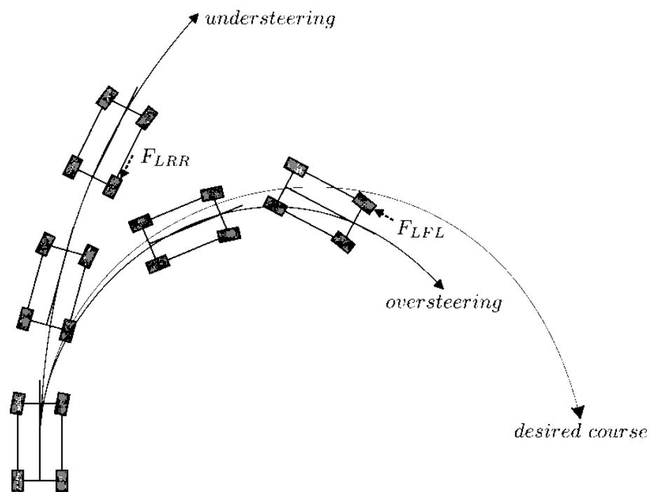
Si può utilizzare una legge di controllo basata sull'uso di una matrice di feed-back che deve essere ricalcolata per ogni punto di lavoro e che utilizza il calcolo delle costanti di slittamento dei pneumatici, la stima della velocità e l'osservazione dell'angolo di slittamento laterale del veicolo.
