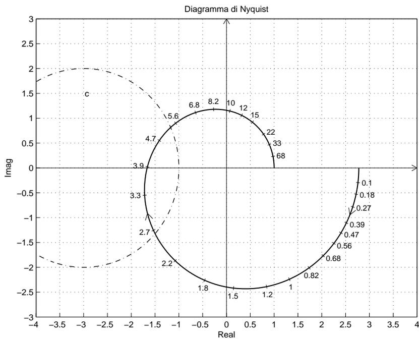
L'intersezione con il semiasse reale negativo si trova scrivendo l'equazione caratteristica del sistema retroazionato e applicando il criterio di Routh:
