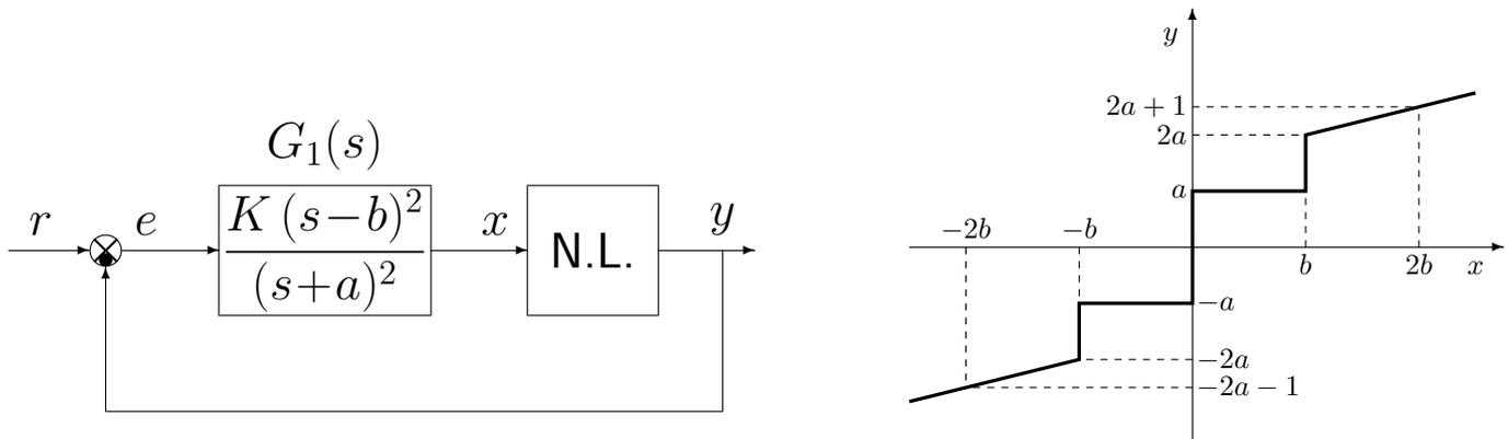
1) Posto  $K = 1$ , determinare per quale valore  $r^*$  del riferimento  $r$  il punto di lavoro del sistema retroazionato coincide con il punto  $(x_0, y_0) = (2b, 2a + 1)$ .
