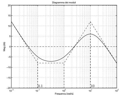
4. In figura è mostrato il diagramma di Bode dei moduli di un sistema lineare  $G(s)$  a fase minima.
