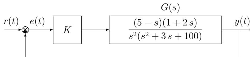
d.1) Determinare per quali valori di  $K$  il sistema retroazionato è asintoticamente stabile.
