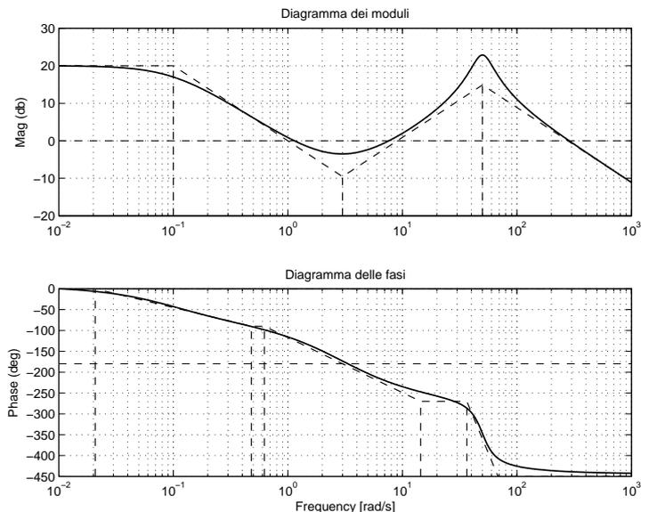
Dal grafico è evidente che la funzione  $G(s)$  ha un polo stabile in  $\omega = 0.1$ , due zeri instabili in  $\omega = 3$  e una coppia di poli complessi coniugati stabili in  $\omega = 50$ . La funzione di trasferimento
