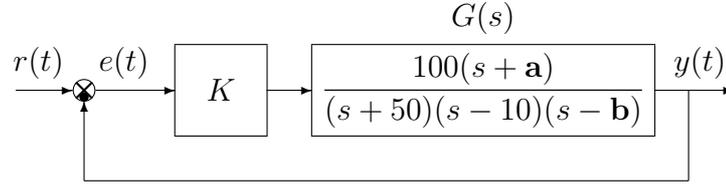
a.1) Tracciare qualitativamente il luogo delle radici del sistema retroazionato al variare del parametro  $K > 0$ . Determinare esattamente la posizione degli asintoti, le intersezioni  $\omega^*$  con l'asse immaginario e i corrispondenti valori del guadagno  $K^*$ . Determinare la posizione dei punti di diramazione "solo in modo qualitativo".
