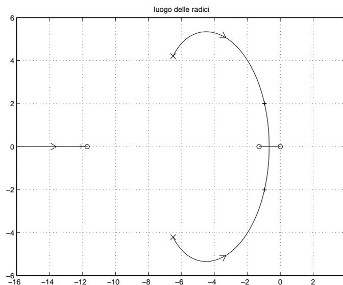
Figura 2: Contorno delle radici del sistema  $G_1(s)$  al variare del parametro  $\tau > 0$  quando  $a = 3$ .
