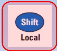
Premendo il pulsante Shift (Local) si disabilita la modalità Remote e il multimetro torna ad essere pilotato dal pannello frontale
