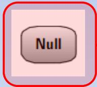
Abilitare la funzione Null: premendo il tasto il multimetro memorizza la lettura successiva in un registro di offset ed immediatamente mostra:
